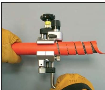
Permet la découpe d'isolant en avance hélicoïdale ou droite pour terminer le dénudage. La longueur de dénudage peut être fixée par une pigne réglable. Outil en alliage d'aluminium dur et colonnes en acier inoxydable.
