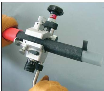
Permet d'enlever tous les types de semi conducteur pelable ou non pelable. Profondeur de découpe réglable par molette graduée en dixième de mm. Une butée escamotable et graduée permet de stopper le travail avec précision. Outil en alliage d'aluminium dur et colonnes en acier inoxydable.
