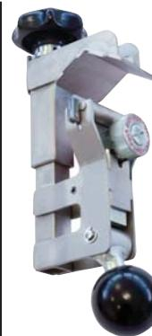
Permet de fendre l'isolant externe pour atteindre et travailler plus facilement le raccordement du semi conducteur. Réglage de profondeur possible par pas à l'aide d'une molette très accessible. Rappel de la lame par ressort.
