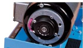
Les machines **SH90**, **AI90** et **GE90** sont équipées d'un capteur de vitesse. Il s'agit d'un alternateur tachymétrique délivrant deux informations proportionnelles à sa vitesse de rotation :
