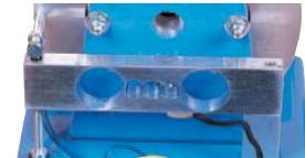
Les machines **GE90** et **FR90** sont équipées d'un capteur de couple. Il s'agit d'une structure en aluminium avec jauge de contrainte en pont de Wheatstone.
