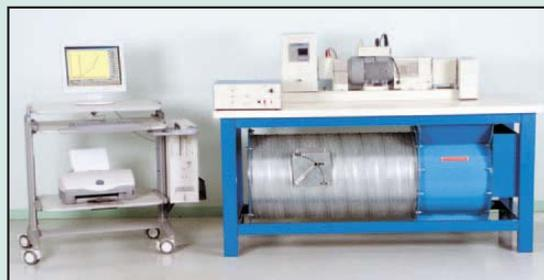
Les versions PC-AIR et PC-AIR-S de ces systèmes sont équipées d'un capteur de couple, d'une dynamo tachymétrique, d'un variateur de vitesse, d'un capteur de débit, d'un boîtier d'acquisition.
