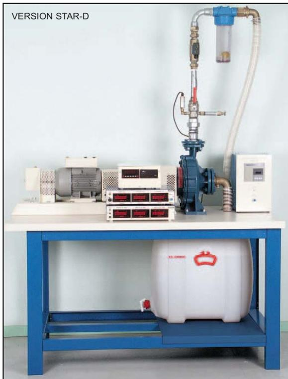
STAR est une station de relevage similaire (à la longueur des tuyaux près), à une installation d'irrigation. Pour une utilisation pédagogique, STAR est équipée de capteurs, destinés à l'étude des grandeurs électriques et mécaniques mises en jeu.
