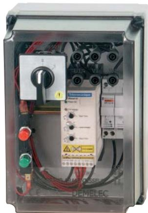
Ce boîtier permet le démarrage et le ralentissement sans à coups, avec courant réduit, de moteurs asynchrones monophasés et triphasés à cage. La totalité des réglages est possible sans ouvrir le boîtier. Ces réglages sont : temps d'accélération, temps de décélération, couple. Les états de fonctionnement " Marche " et " vitesse nominale " sont signalés par voyants.
