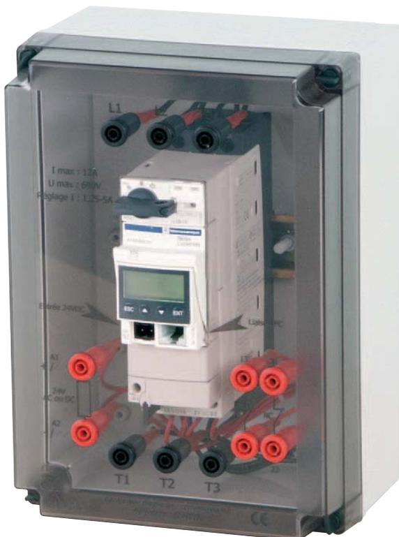
CONTYS issue de la mécatronique, est un départ moteur Télémecanique® alliant les technologies mécaniques, électrotechniques et électroniques. Il est destiné au démarrage direct des moteurs jusqu'à 3kW. Compact, il regroupe en un seul produit les fonctions de puissance (sectionnement, commutation) et de contrôle (protection). Un écran numérique permet de programmer et de visualiser les paramètres moteurs.
